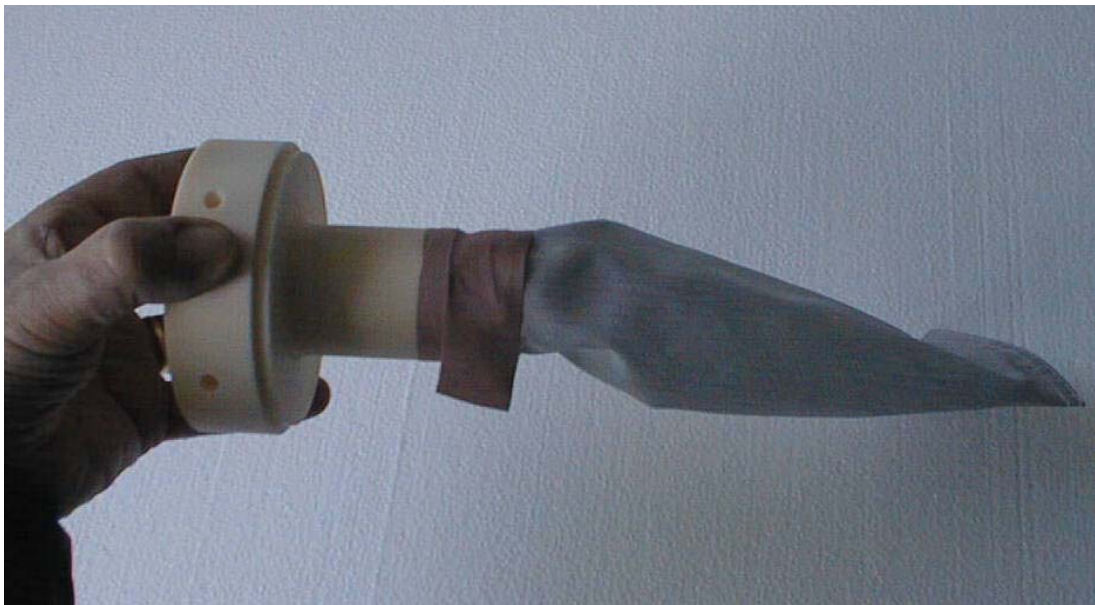
JMRS 80: Chambre de broyage en céramique avec deux buses (au total 5) et un filtre.
