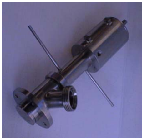
Vanne pneumatique en version stérile. Contrôle de position ouverte ou fermée. Ressort de maintien en position fermée. Positionneur mécanique.
