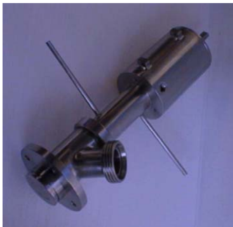
Vanne pneumatique en version stérile. Contrôle de position ouverte ou fermée. Ressort de maintien en position fermée. Positionneur mécanique.
