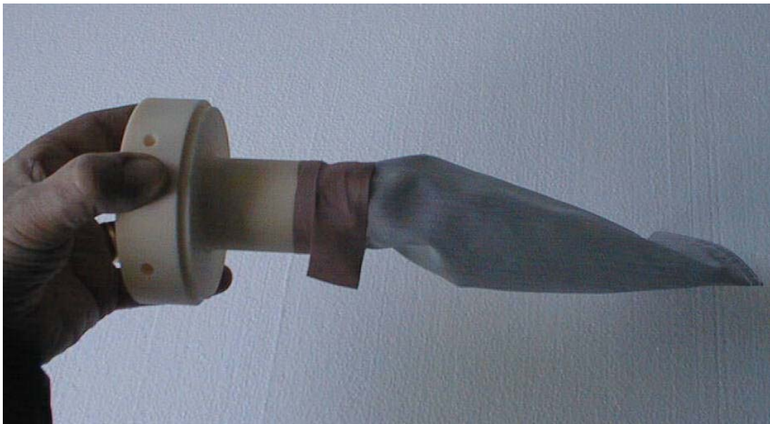
JMRS 80 SQ: Keramik-Gehäuse mit zwei sichtbaren Luftdüsen (total fünf) und Filtersack
